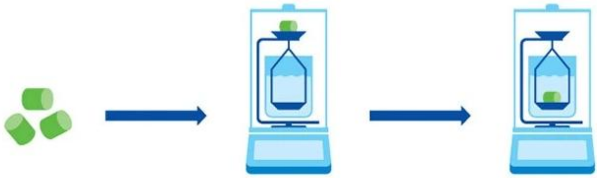
Şekil 1. BS EN ISO 1183-1 Standardına göre bir deney numunesinin yoğunluk ölçümü
